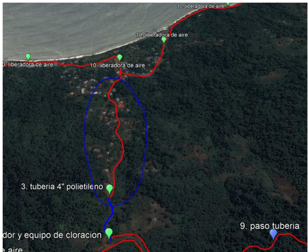
4. **Tubería de polietileno 4" sdr 13.5 PEAD, distancia 1.5 km paso de tubería por el puente y válvulas reguladoras:** en este punto se hará un paso a nivel al lado del puente y se instalará la tubería de polietileno de 4" hasta el EBAIS viejo.
